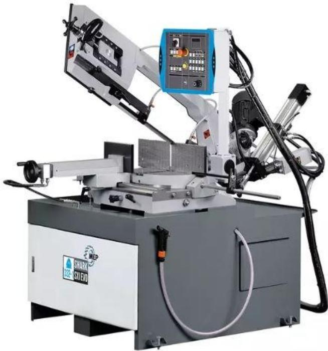
**La segatrice semiautomatica elettroidraulica a nastro SHARK 332-1 SXI EVO per il taglio di metalli da -45° a +60°, è dotata oltre al ciclo di taglio semiautomatico, anche del ciclo semiautomatico dinamico e manuale. CHIAMACI PER CONFIGURARLA COME DESIDERI, RITIRIAMO IL TUO USATO!**
