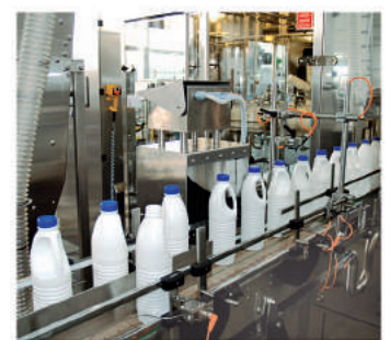
Rejection of nonconforming containers onto a parallel conveyor Отвод отбракованных бутылок на параллельный конвейер
