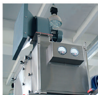
Sterile air filtration system for the air entering the working zones Система для стерилизации воздуха, поступающего в рабочую камеру
