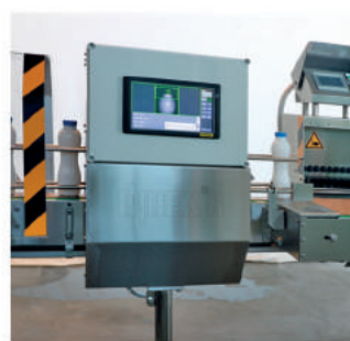
Weight and cap monitoring system with an automatic rejection device Устройство для проверки точности дозирования и наличия крышек
